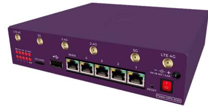
banda realmente a disposizione. Qualora ci fossero problemi di prestazioni della connessione, il pCaster 2020 è in grado di passare, senza sganci e senza perdite della qualità del segnale, alla connettività di backup. Al router pCaster 2020 possono essere connesse in backup connessioni 4G-LTE, connessioni satellitari Eutelsat OpenSKY oppure le nuove connessioni satellitari ad alte prestazioni StarLink di SpaceX e Kuiper di AWS.
